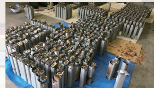
過去に民間事業者で使用され、掘り起こし調査の結果、取り外された高濃度安定器
