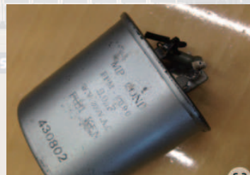
蛍光灯安定器の中にコンデンサ
